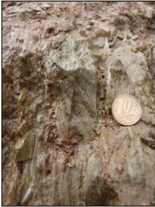
Figura 31 - Juntas de cisalhamento, milimétricas e fechadas, de direção N70E/83NW. Feição característica da fase rúptil da ZCC.
