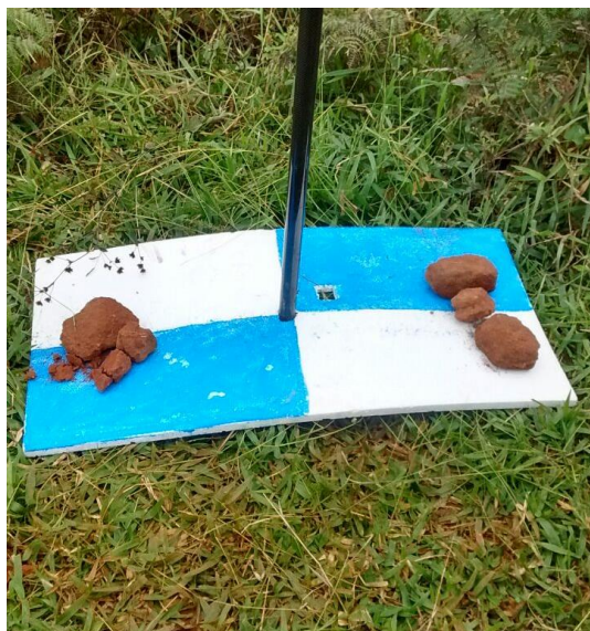
Figura 5. Elementos artificiais utilizados como pontos de controle.
