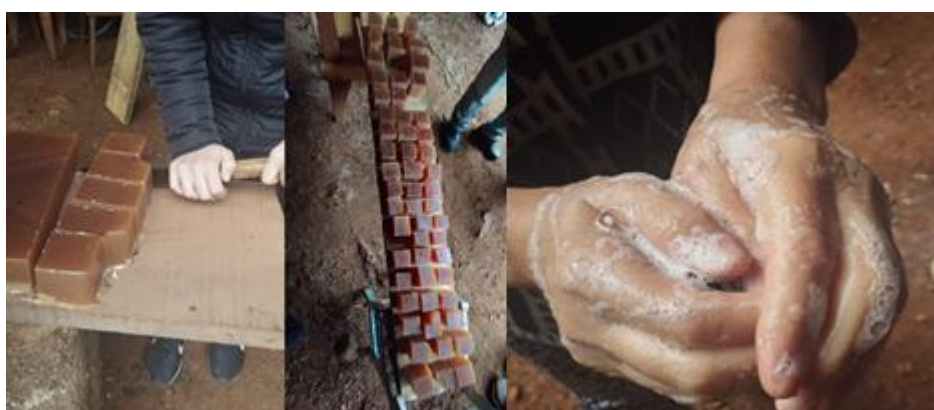
Figura 4 – Recorte do sabão artesanal para entrega das amostras aos envolvidos na atividade e Verificação da formação de espuma pelo sabão produzido na oficina
